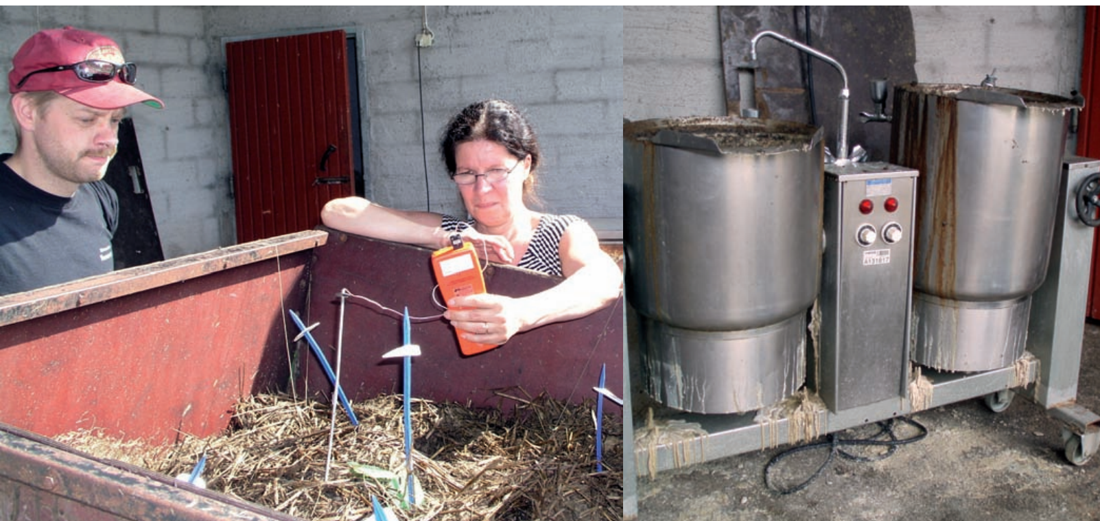
Juha Vuorenmaa ja MTT:n tutkija Marja Lehto mittaavat kompostin lämpötilaa Vuorenmaan pienteurastamolla Ulvilassa (vas.) Kuva: Heidi Valtari ja Pienteurastamon sivutuotteet kuumennettiin kippikattiloissa +70°C:een tunnin ajaksi (oik.) Kuva: Marja Lehto.
